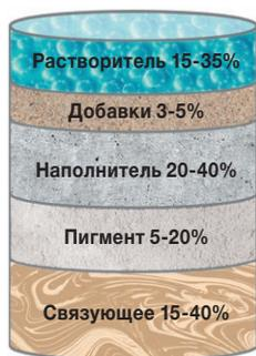
**Растворитель** поддерживает материал в жидком виде до нанесения на поверхность, отвечает за время высыхания ЛКМ.
